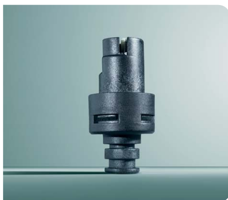
Tlakový senzor neustále kontroluje tlak vody v topném systému a ihned reaguje na pokles tlaku odstavením kotle z provozu s následným chybovým hlášením.
